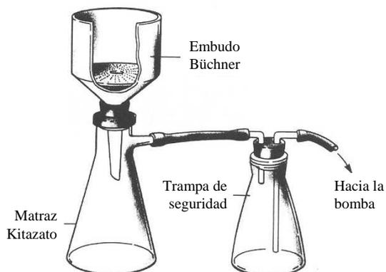
Figura 1. Equipo de filtración en vacío.
